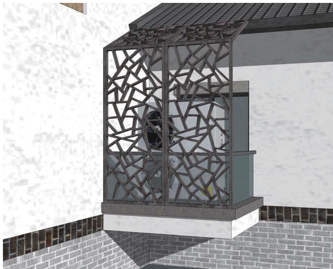
图6.3-2 设备平台室外机装饰格栅遮挡
